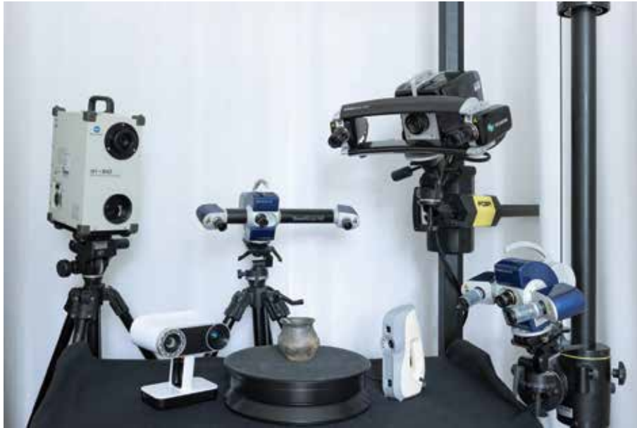
Abb. 1. Die am LfA Sachsen verfügbaren Scanner für die 3D-Dokumentation (Stand 2024). Im Hintergrund des Bildes stehen rechts neben dem Laserscanner Konica Minolta VI-910 drei Streifenlichtscanner der Firma Hexagon, vormals AICON. Auf dem Tisch davor befinden sich zwei Handscanner des Herstellers Artec (© Landesamt für Archäologie Sachsen. Aufnahme: T. Reuter)
